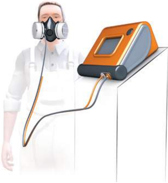
(Essai d'ajustement quantitatif
