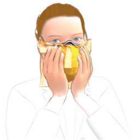
( Test d'étanchéité à pression négative
