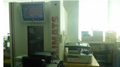
Équipement no 53 | Étuve climats Description : P = 10,8 kVA Localisation :
